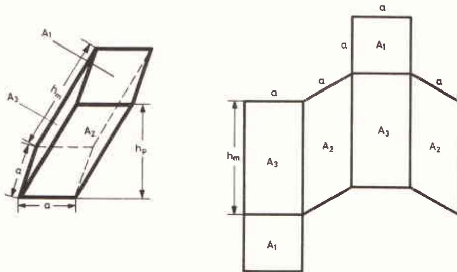
Abb. 38 Schiefes Prisma mit quadratischer Grundfläche
