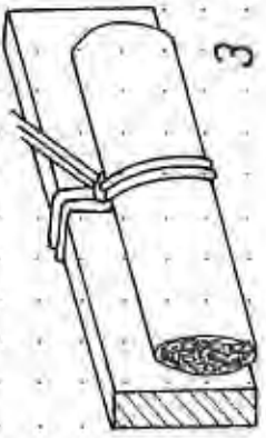
Bindungen für Kabel, die zum Flacheisen parallel laufen
