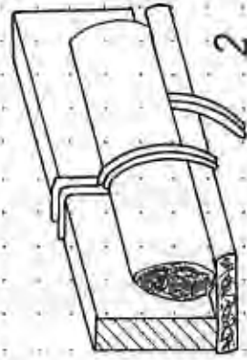
Bindungen für Rund-u-Flachkabel an den Armen des Hauptverteilers.
