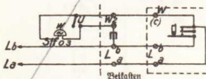
\* Die Tischfernsprecher ZB 06a weichen in der Schaltung von der dargestellten Schaltung ab, die Klemmenlage und die Schaltung des besonderen Weckers ist aber die gleiche.
