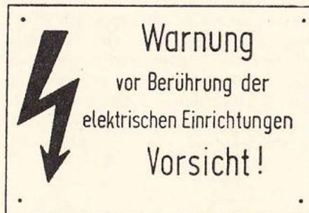
Warnschild für Anlagen mit Spannungen über 250 V gegen Erde und an Stellen mit erhöhter Gefährdung für Anlagen bis 250 V gegen Erde
