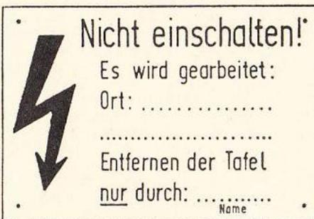
Warnschild für Schaltstellen, an denen für die Dauer von Arbeiten ausgeschaltet wurde
