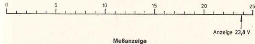
$$\text{Der Nennstrom beträgt: } I_N = \frac{U_{\text{Mess}}}{R_N} = \frac{23,8 \text{ V}}{910 \Omega} = 26,2 \text{ mA}$$
