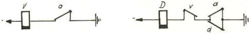
Bei Ende des 1. Impulses <sup>zieht</sup> fällt A-Relais <sup>an</sup> ab, D-Relais zieht an und schaltet sich einen Haltestromkreis. V-Relais ist abfallverzögert und hält sich. Der Wähler dreht sich noch nicht da beide Motorspulen parallel über v-hr-a-m<sup>1</sup> liegen. Bei Beginn des 2. Impuls <sup>fällt</sup> zieht das A-Relais wieder <sup>ab</sup> an. a-Kontakt öffnet die Parallelschaltung der Motorspulen. Der Wähler dreht sich.
