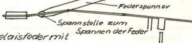
Spannen einer Relaisfeder mit Hilfe eines Federspanners
