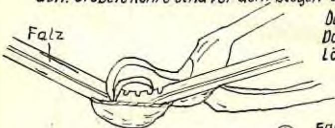
Das Rohr wird durch Einkerbungen gebogen. Darauf achten, daß der Falz seitlich im Löffel liegt u. nicht eingekerbt wird.
